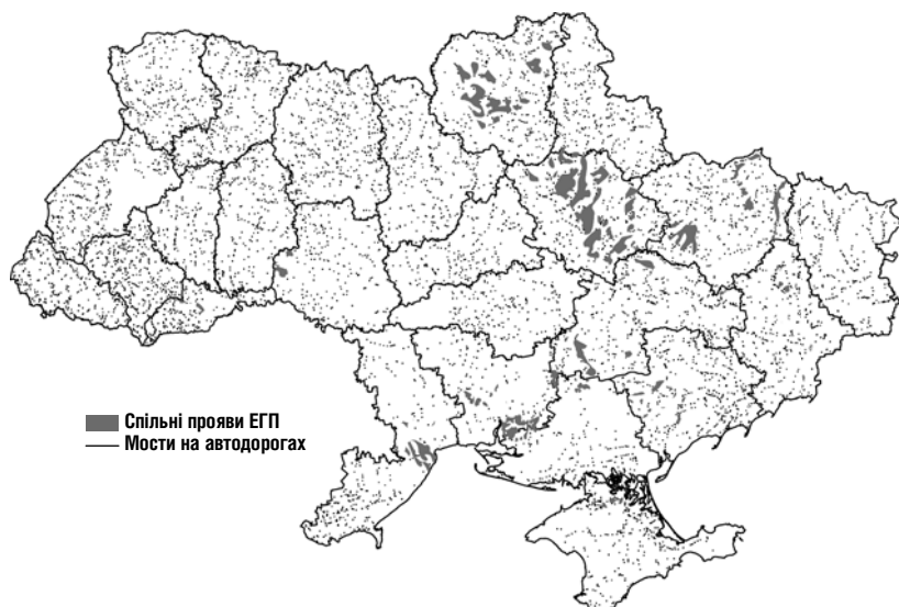
Рис. 3.19. Загрози від спільного прояву ЕГП (карст, підтоплення, просідання) для безпеки експлуатації мостів на території України [8]
