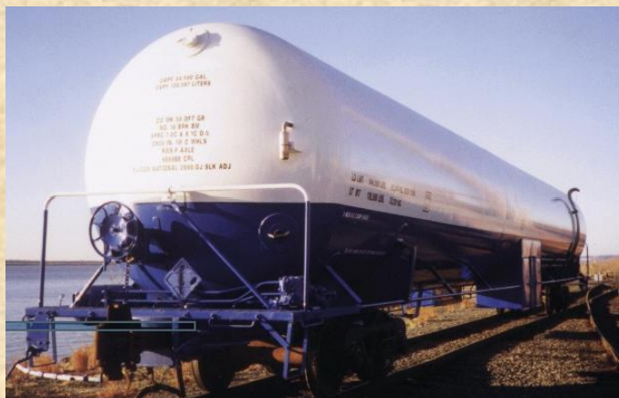
Рис. 3 - залізнична цистерна для перевезення СПГ (США)
