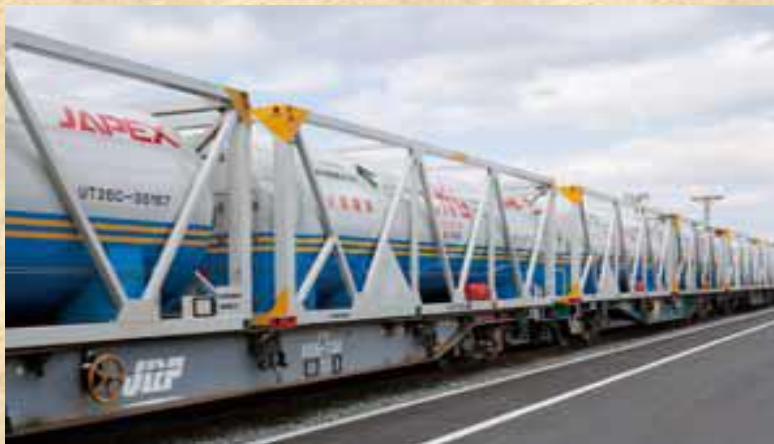
Рис. 1 - Вантажний потяг з блок – контейнерами для перевезення СПГ японської компанії JAREX
