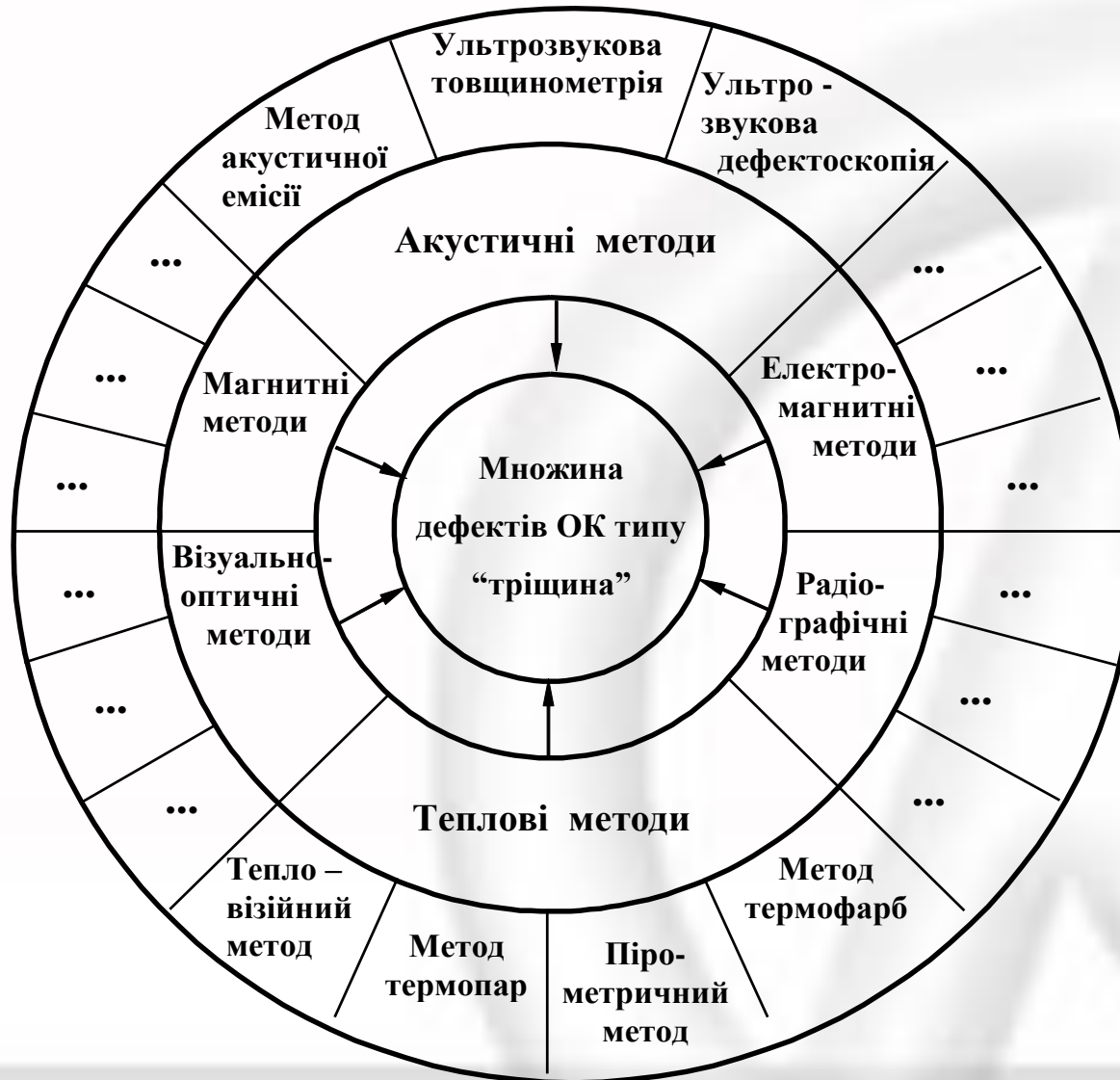
Комплекс МНК для виявлення дефекту типу "тріщина"
